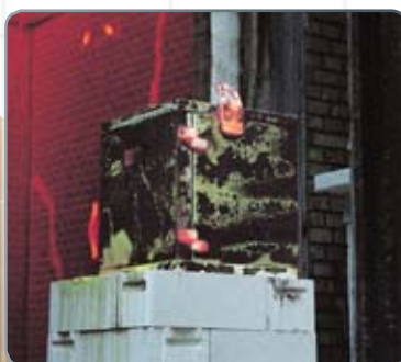
Remoção do cofre-forte do forno
