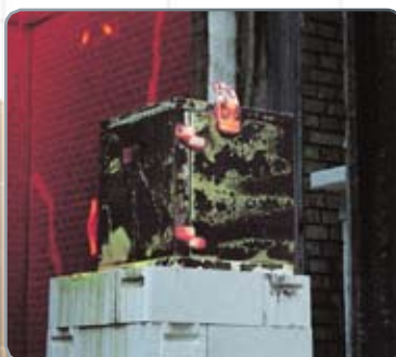
Remoção do cofre-forte do forno
